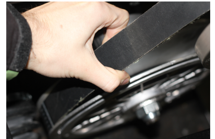
Рис. 7.7. Снятие ремня вариатора
