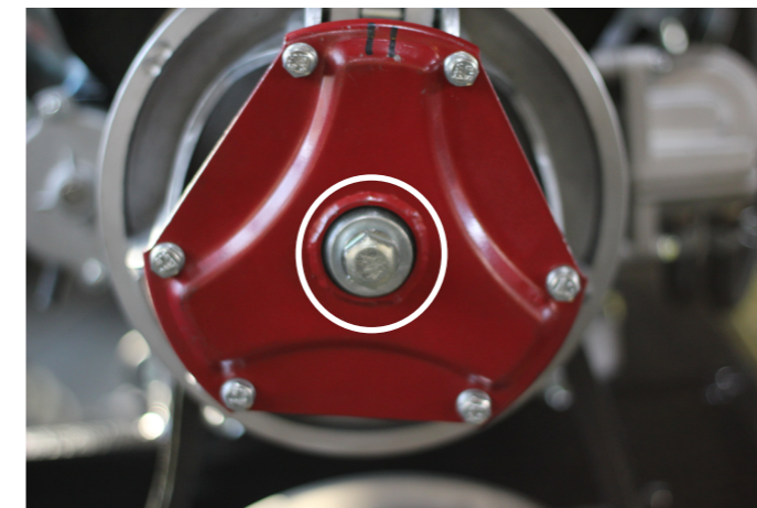
Рис. 7.6. Фиксирующая гайка вариатора
