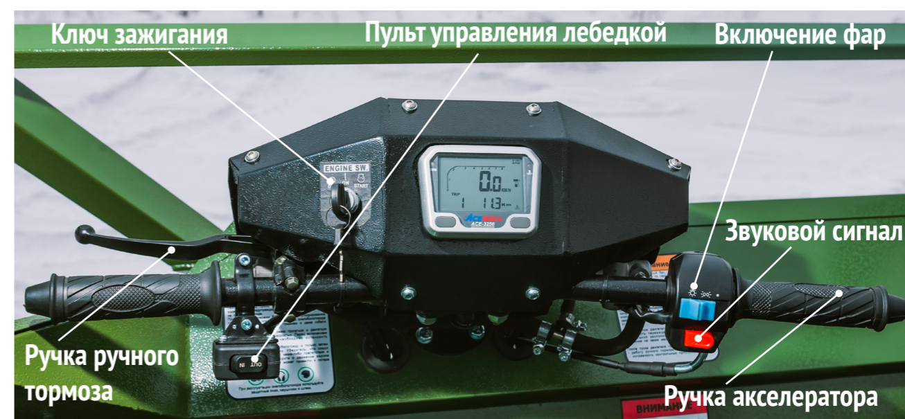
Рис. 1.6.1 Элементы управления движением вездехода
