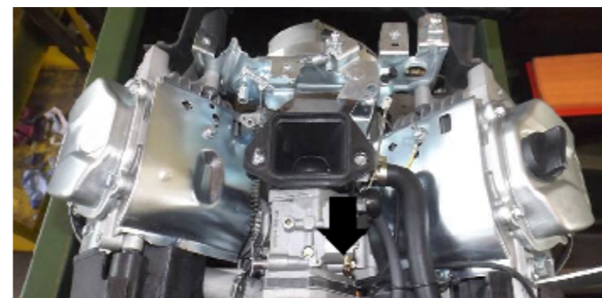
Рис. 2.6.1 Проверка уровня топлива
