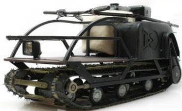
Мощный и проходимый. Гусеница расширена до 550 мм металлическим профилем.
