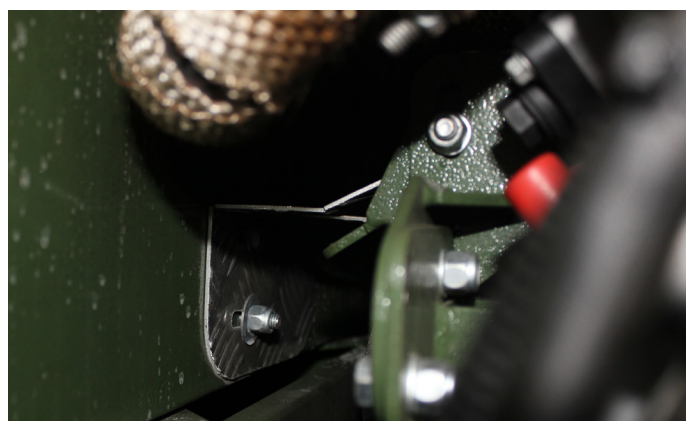
Рис. 7.9.4 Крепление термоизоляции к задней стенке корпуса вездехода
