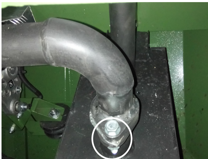
Рис. 7.9.2 Место крепления выпускного коллектора к двигателю вездехода
