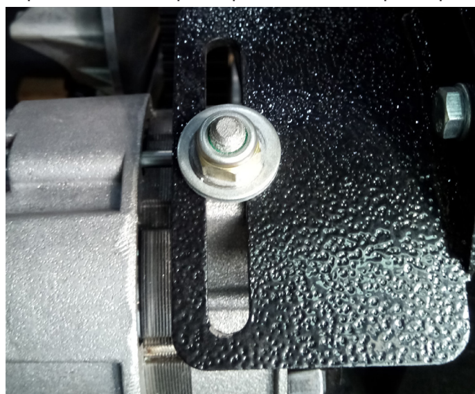
Рис. 7.9.5 Натяжной болт генератора
