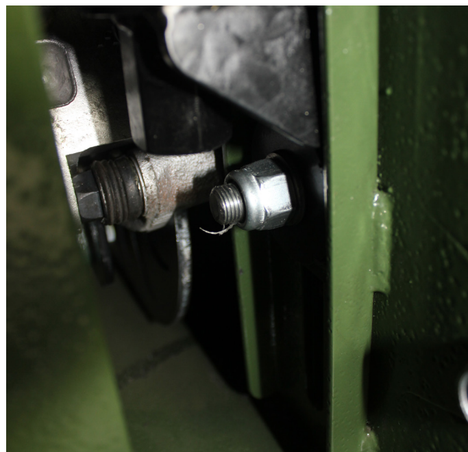
Рис. 7.2.3.1 Болт - фиксатор ролика - натяжителя
