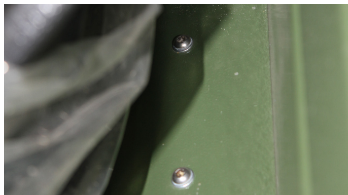
Рис. 7.9.3 Крепление термоизоляции к корпусу вездехода, за задними пассажирскими сидениями
