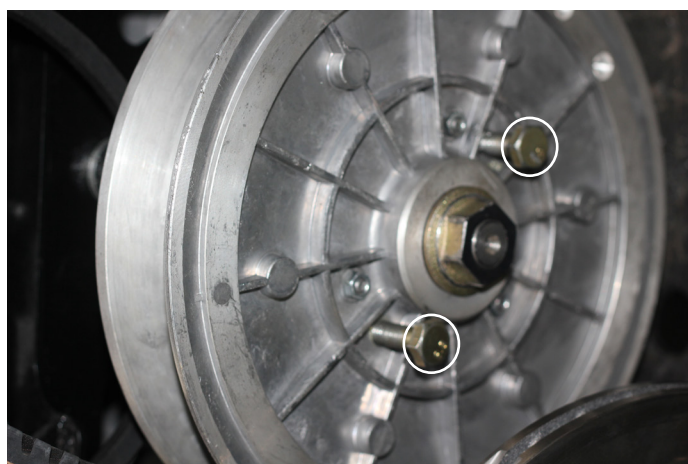
Рис. 7.7. Регулировочные болты на ведомом вариаторе
