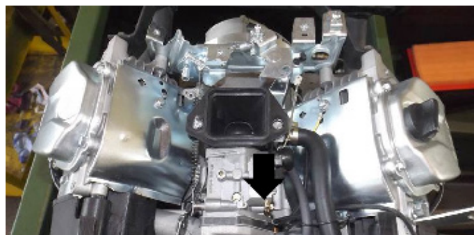
Рис. 2.6.1 Проверка уровня топлива
