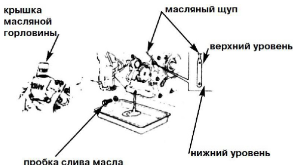
Рис. 6-1. Отверстие для залива масла и замера уровня масла
