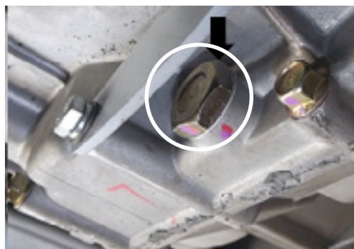
Рис. 6.2.2.3 Расположение сливной пробки
