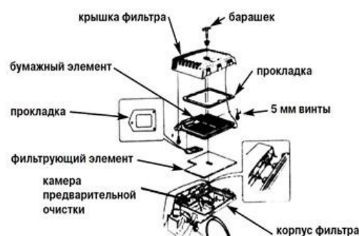
Рис. 6.5.1. Расположение воздушного фильтра
