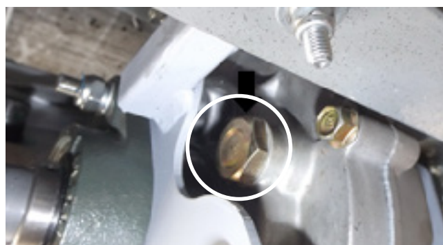
Рис. 6.2.2.2 Расположение заливной пробки на КПП
