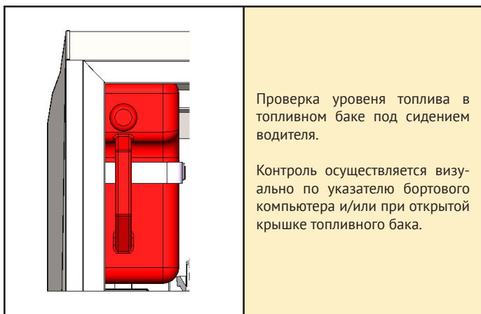
Рис. 2.2.1 Проверка уровня топлива
